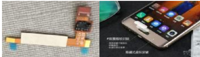
图 11 基于低翘曲薄型 via-last TSV SiP 的指纹模组和华为 mate9 产品
