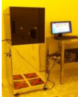
图 5 TSV 孔底膜厚测量设备样机
